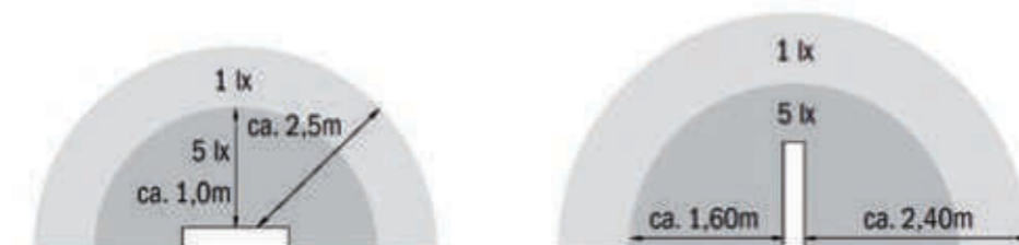
Lichtverteilung - gemessen 1m über dem Boden, Montagehöhe der Leuchte 2,20m
