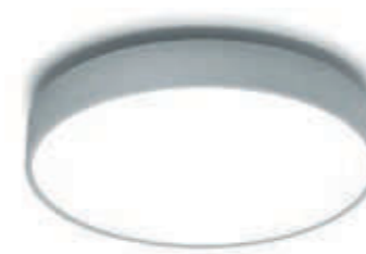
LED-Anbauleuchte direkt/indirekt 5489505 930lm 15W Ø300xH80mm 5489507 1730lm 30W Ø400xH80mm 5489509 3290lm 45W Ø600xH80mm
