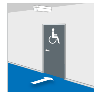
Nahe (max. 2 m Abstand) Schutzbereichen für Menschen mit Behinderung und Rufanlagen und Alarmierungseinrichtungen in Toiletten für Menschen mit Behinderung sowie eine Antipanikbeleuchtung in Toiletten für Menschen mit Behinderung.
