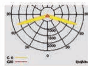
Projektionshilfe für Micropoint 2 EAT – Asymmetrische Lichtverteilung für E=1,0 lx Messebene 0,02 m, Wärmefaktor WF = 80 %, Batteriebetrieb, Abstände in m
